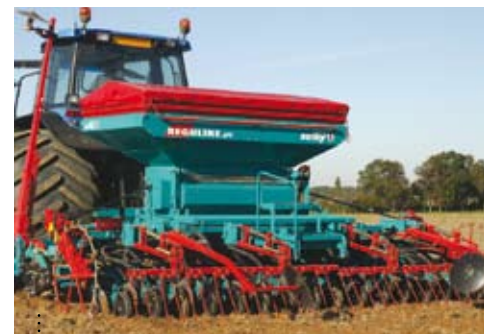
La sécurisation du semis se fait par un rayon, s'il est coupé par une accumulation de semence, l'alarme est déclenchée.
